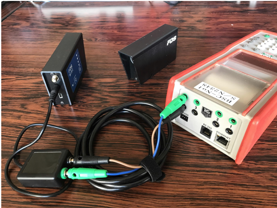
既存、CP540/545 と FDS製光電センサーの接続
